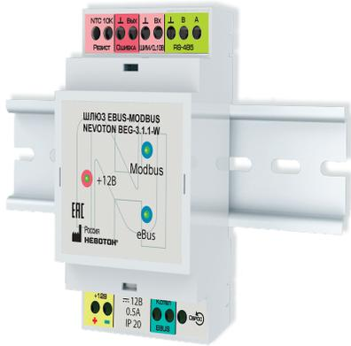
Шлюз EBus-Modbus NEVOTON BEG-3.1.1-W предназначен для удаленного управления котлами отопления, производства фирм **Protherm и Vaillant**, оснащенных шиной EBus, и интеграции в системы автоматики под управлением ПЛК (PLC), работающих по протоколу Modbus RTU RS-485 (типа Wrenboard 6, OBEH ПЛК63/73, SIEMENS SIMATIC, контроллеры, выпускаемые компаниями Allen-Bradley, Rockwell Automation, Schneider Electric, Omron и др.).
